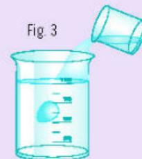
Lo que hicimos fue cambiar la densidad del agua, puesto que el huevo se mantenía en las mismas condiciones que al inicio del experimento. De lo anterior concluimos que en agua simple el huevo se hunde porque su densidad es mayor que la del líquido. Al agregar la sal, la densidad del agua aumenta, por lo que el huevo flota; después, al diluir el agua salada, su densidad va disminuyendo, por tanto, el huevo se hunde nuevamente. De este modo, probamos que nuestra hipótesis era verdadera.
