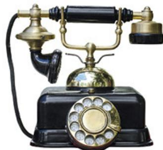
**Figura 18.11** Los teléfonos transformaron las telecomunicaciones gracias a la posibilidad de convertir el sonido en electricidad y viceversa.
