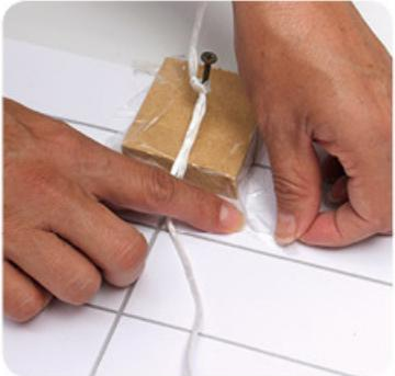
**Figura 14.6** El clavo se fija en una pieza de madera para no dañar la pared.
