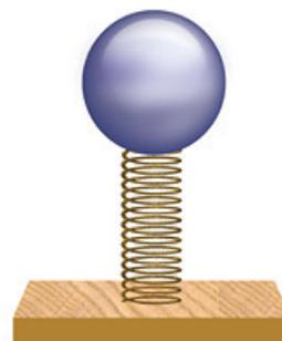
**Figura 14.8** La bola encima de un resorte comprimido será lanzada hacia arriba.
