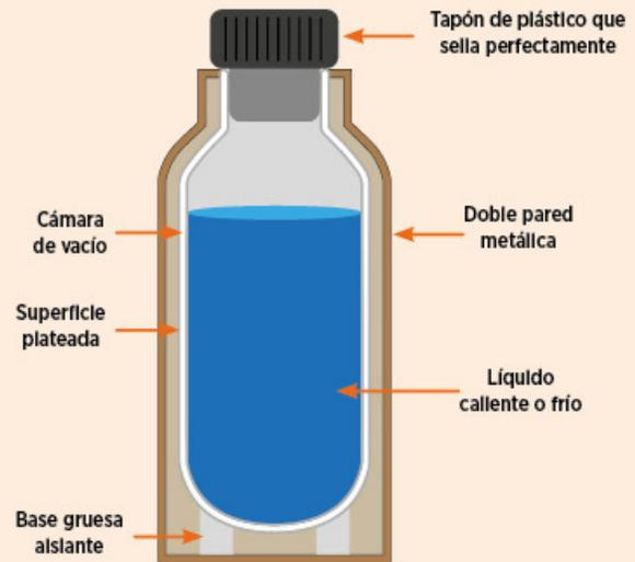
Figura 4.18 Estructura de un vaso Dewar.
