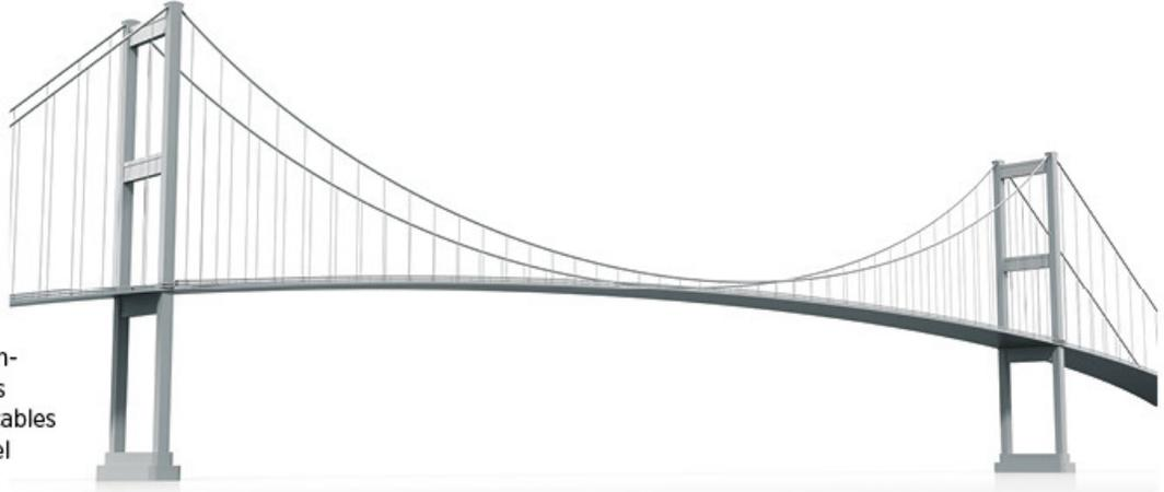
**Figura 2.6** Puente colgante donde se observan las columnas de carga, los cables principales y tirantes, y el tablero o piso.
