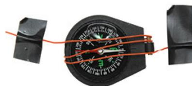
Figura 15.11 Brújula con vueltas del cable antes de conectar la batería.
