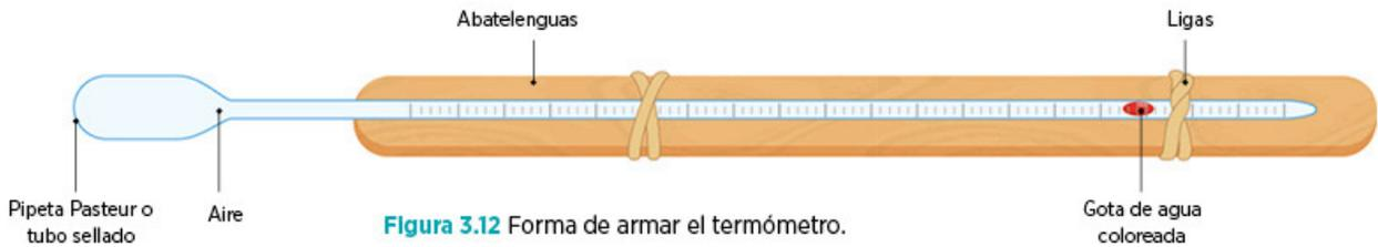
**Figura 3.12** Forma de armar el termómetro.
