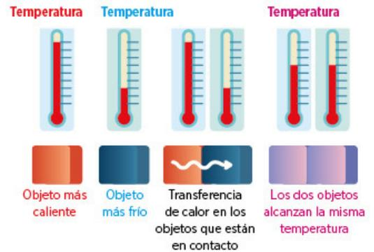
Figura 3.13 Representación esquemática del equilibrio térmico entre dos objetos.
