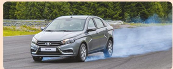
**Figura 12.13** Cuando las ruedas se detienen y el auto sigue en movimiento, la fuerza de fricción disminuye.
