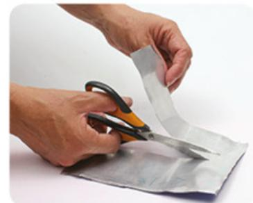
Figura 5.7 Cómo preparar la lámina para el motor.
