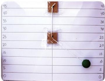
**Figura 14.7** El péndulo alcanza determinada altura después de que el hilo toca el segundo clavo.
