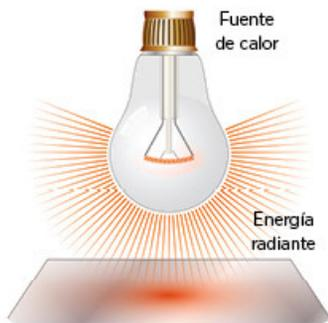
**Figura 4.15** Transferencia del calor por radiación.
