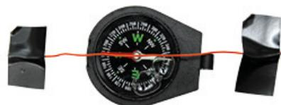
Figura 15.9 Brújula con cable encima antes de conectar la batería.
