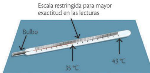
FIG. 13.3 Partes de un termómetro clínico.
