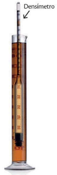
FIG. 3.12 Densímetro: material de laboratorio que sirve para calcular la densidad de líquidos tomando como referencia la densidad del agua, es decir, el valor que muestra es el de la densidad relativa de un líquido.
