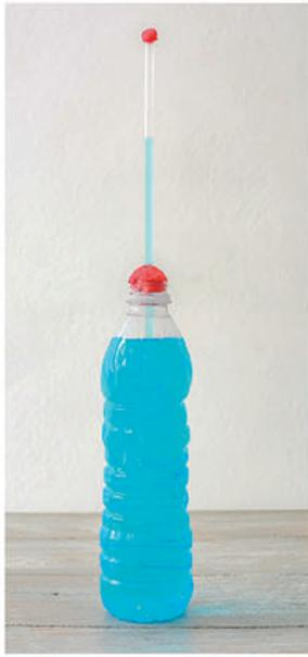
FIG. 13.8 Termómetro terminado. Observa cómo debe quedar sellada la tapa con la plastilina.
