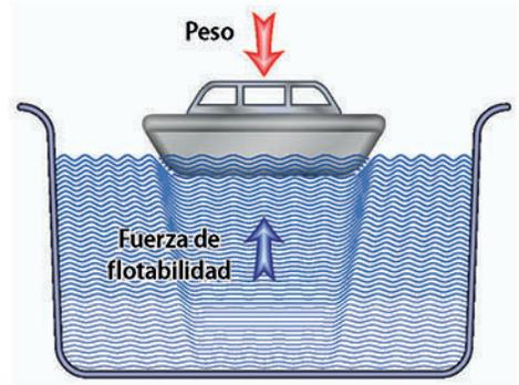
FIG. 3.11 En los barcos que flotan hay un equilibrio entre dos fuerzas: el peso (representado por una flecha roja) y la fuerza de flotabilidad (representada por una flecha azul). Si se rompe este equilibrio, el barco se hunde.
