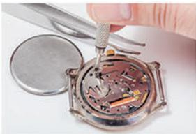
**FIG. 23.8** Reloj de cuarzo, que es el material que genera los impulsos para medir el tiempo.
