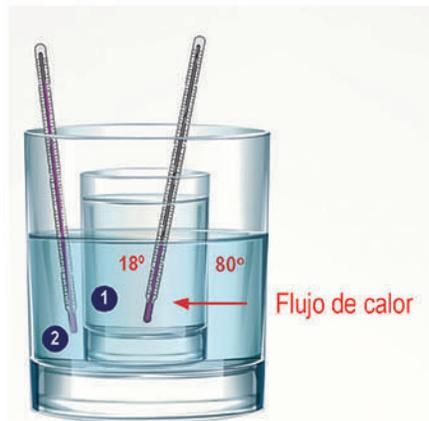
**FIG. 7.12** Dirección del flujo de calor.
