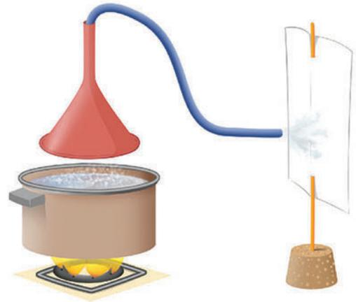
FIG. 7.4 Dispositivo que transforma la energía calorífica en otros tipos de energías.
