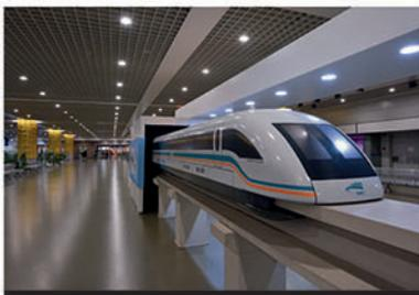
**FIG. 23.3** Primer tren de alta velocidad que opera por levitación magnética construido en Shanghai en 2004, y el cual alcanza velocidades superiores a los 400km/h.
