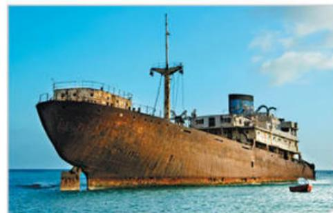
Figura 4.38 Ejemplo de corrosión húmeda.
