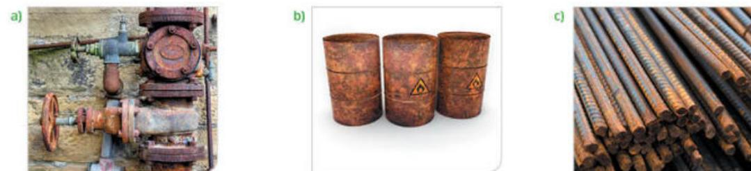
Figura 4.39 Entre otros objetos: a) la corrosión afecta la maquinaria y los dispositivos, los hace disfuncionales; b) a contenedores de metal, que los convierte en un peligro potencial, y c) a materiales de construcción que se tornan inservibles.
