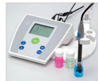
Figura 4.15 El potenciómetro se emplea para medir el pH de una disolución. El electrodo se sumerge en la muestra y detecta la concentración de iones H<sup>+</sup>.
