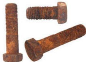
Figura 4.37 Ejemplo de corrosión seca.
