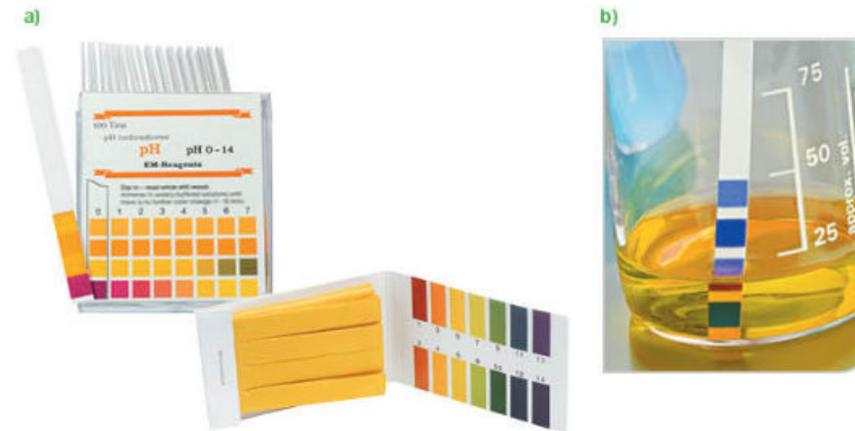
Figura 4.7 a) Dos variedades de papel pH y b) para utilizar las tiras, se sumergen en la disolución y luego se comparan los colores con la escala impresa en el empaque.
