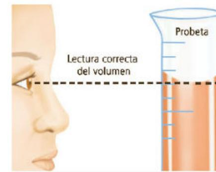
Fig. 1.17. Medición con probeta.
