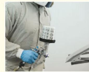
Fig. 4.28. Recubriendo el metal con una pintura especial, se evita que el metal se oxide rápidamente.
