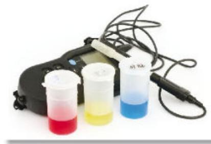
Fig. 4.6. El pH-metro puede dar medidas imprecisas cuando la membrana de vidrio está sucia con grasa o material orgánico insoluble en agua.
