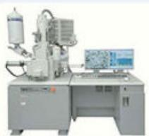
Microscopio electrónico de barrido.
