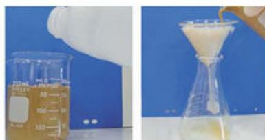
Sistema de filtración por gravedad.
