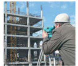
El teodolito, junto con otras herramientas auxiliares, puede medir distancias y desniveles.
