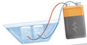
**Figura 2.5** Dispositivo para paso de corriente eléctrica hacia las disoluciones.
