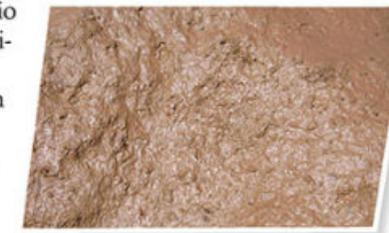
Figura 4.21 El óxido de aluminio o alúmina, junto con la sílice, es el ingrediente más importante en la constitución de las arcillas, cuya fórmula es  $\text{Al}_2\text{O}_3 \cdot 2\text{SiO}_2 \cdot \text{H}_2\text{O}$ .
