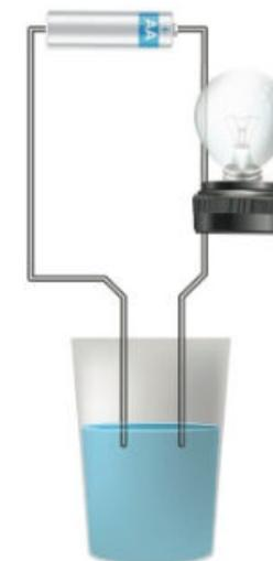
Esquema que muestra el procedimiento para probar la conductividad eléctrica de un líquido
