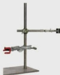
3. *Soporte universal*. Es una base metálica con un poste alto que se utiliza en el armado de muchos equipos de laboratorio, se complementa con anillos de metal, malla de alambre con asbesto y diversas pinzas de sujeción.
