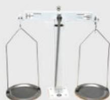
2. *Balanza*. Sirve para medir masa, hay balanzas que funcionan digitalmente, otras son mecánicas como las granatarias. Algunas tienen dos platillos y otras uno solo. Cuando se coloca alguna materia sobre el plato de medición, se determina la masa.
