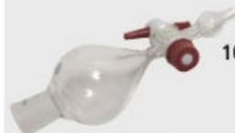
10. *Embudo de separación*. Es un tipo de embudo que permite abrir o cerrar el flujo del líquido que contiene, de modo que logra separar un líquido de otro.
