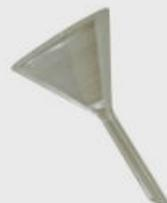
9. *Embudo*. Elemento de vidrio con la boca ancha y base alargada en forma de tubo abierto en el fondo, que permite trasvasar líquidos de un recipiente a otro, evitando que se derramen; también se emplea para la filtración de líquidos.
