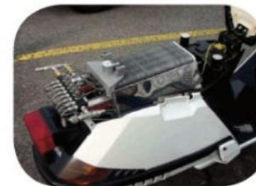
**Figura 5.15** Un vehículo con celda de combustible funcionando con hidrógeno tiene casi el doble de eficiencia que uno de combustión interna a base de gasolina. © 3.0 Ralf Roletschek.
