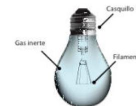
**Figura 2.28** El tungsteno (W) se utiliza en los filamentos de los focos incandescentes.
