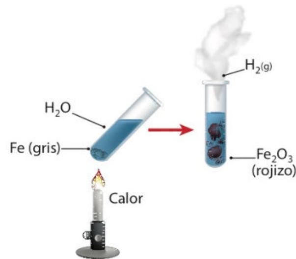
Figura 1.40 Producción en laboratorio de óxido férrico, por medio de la reacción química entre agua ( $H_2O$ ) y hierro metálico (Fe) en presencia de una fuente de calor.
