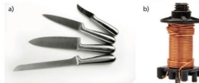
**Figura 2.5** Clasificación de los materiales: a) mezcla homogénea de hierro y carbono (acero), y b) sustancia pura (cobre).
