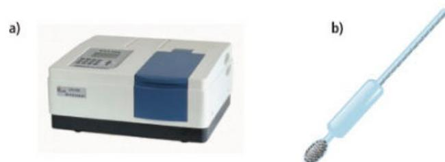
**Figura 1.32** Instrumentos de medición cuantitativos: a) espectrofotómetro de UV-Vis, mide la intensidad del cambio de color de una mezcla; b) densímetro, mide la densidad de una sustancia.
