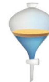
**Figura 1.24** Embudo de extracción. Cuando la mezcla se ha separado por densidad y se abre la llave de paso, el líquido más denso se separa.
