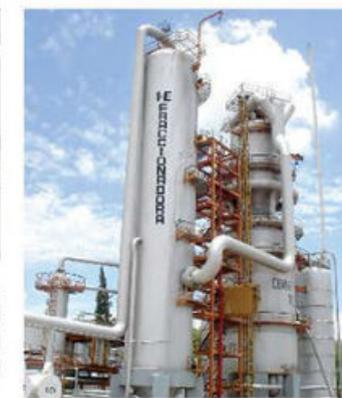
**Figura 1.15** Para separar los componentes de una mezcla como el petróleo el principio de funcionamiento es igual que en la figura anterior, pero el proceso se realiza en un dispositivo que se conoce como torre de fraccionamiento.
