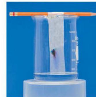
**Figura 1.17** Montaje de una cromatografía en papel.
