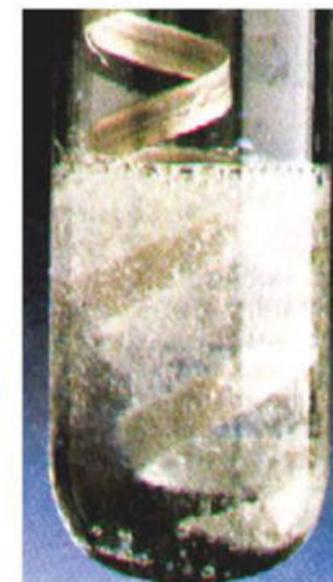
**Figura 4.9** Podemos distinguir un ácido fuerte cuando en presencia de un metal se forma gas hidrógeno (H<sub>2</sub>) y una sal que queda disuelta en el agua. En este caso se trata de una tira de metal de magnesio reaccionando con ácido clorhídrico en un medio acuoso.
