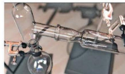
**Figura 1.14** En un destilador se llevan a cabo dos procesos físicos contrarios: primero, la sustancia más volátil se evapora, es decir, se separa de la mezcla para pasar en forma de gas por el tubo inclinado, en donde se condensa y vuelve a la fase líquida pero ya purificada.
